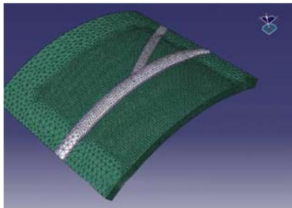
**Рис. 6:** Детальная геометрическая модель сварного шва с использованием методики микромоделирования
