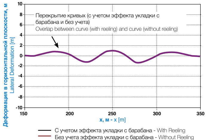
Рис. 7 : Смещение трубопровода при смятии в горизонтальной плоскости
