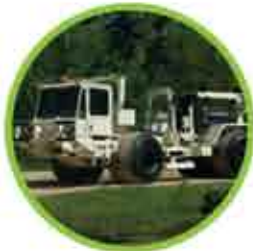
AHV-IV™ - Стандартизованный в промышленности вибратор на колесном шасси
