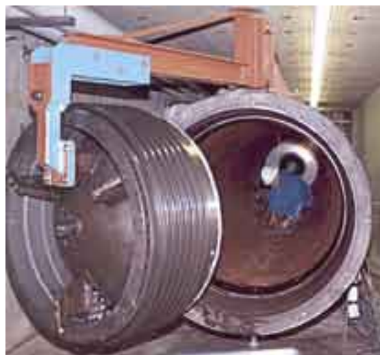
Рис. 8 – Глубоководная экспериментальная камера C-FER Figure 8 – C-FER's Deepwater Experimental Chamber
