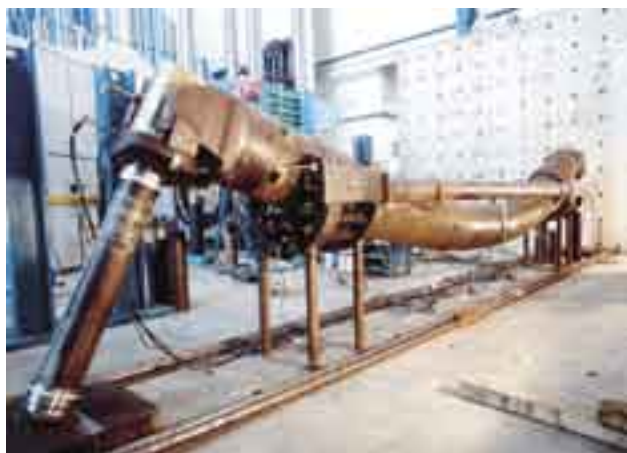
Рис. 12 – Фотография конфигурации системы при испытаниях на изгиб Figure 12 – Photo of the Bend Test Setup
