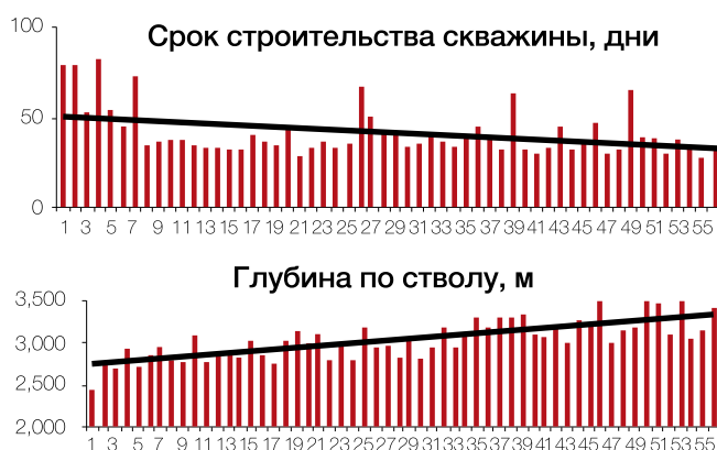
Рис. 4. Пример оптимизации проекта. В ходе реализации проекта было пробурено свыше 50 скважин с увеличенной общей длиной, при этом сроки строительства скважин были сокращены более чем на 15 %
