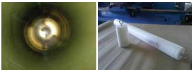
Рисунок 9. Внутреннее пластиковое покрытие СБТ и нейлоновые проходные шаблоны Figure 9. Internal Surface of SBT and Nylon Drift Diameter Gages
