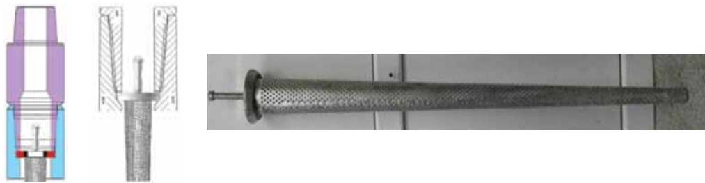
Рисунок 8. Укороченный переводник верхнего привода и новое кольцо фильтра Figure 8. Shortened Top-Drive Adapter and New Filter Pin
