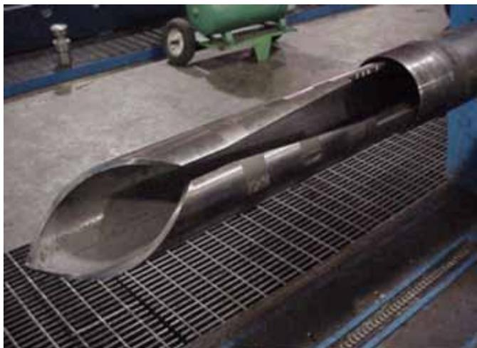
Рисунок 32. Расширяемая подвеска системы многоствольного заканчивания
