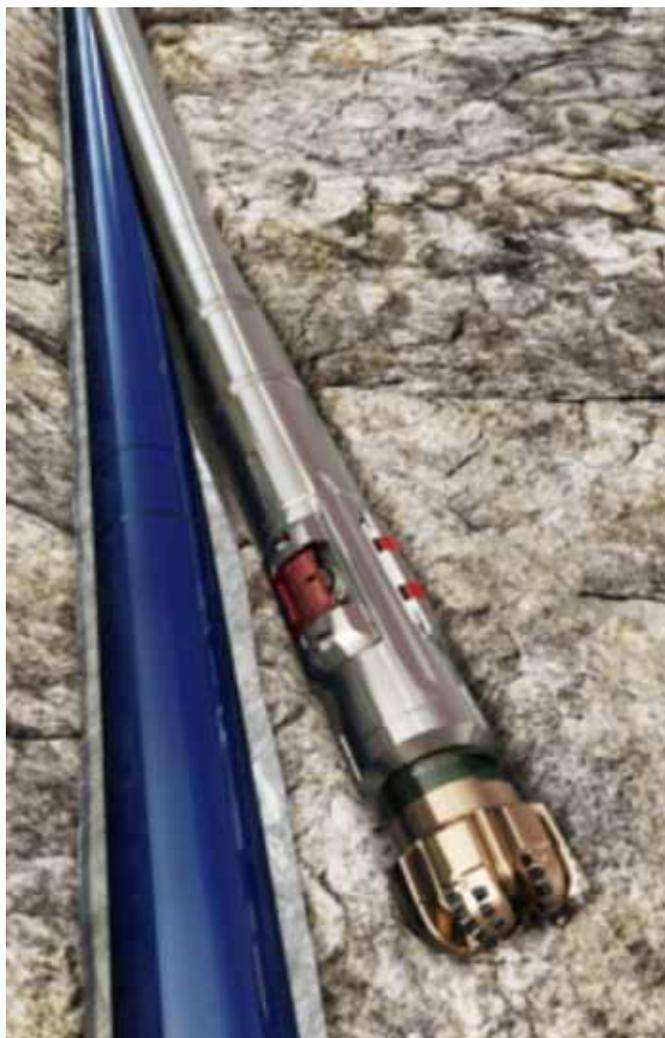
Рисунок 31. Бурение бокового ствола
