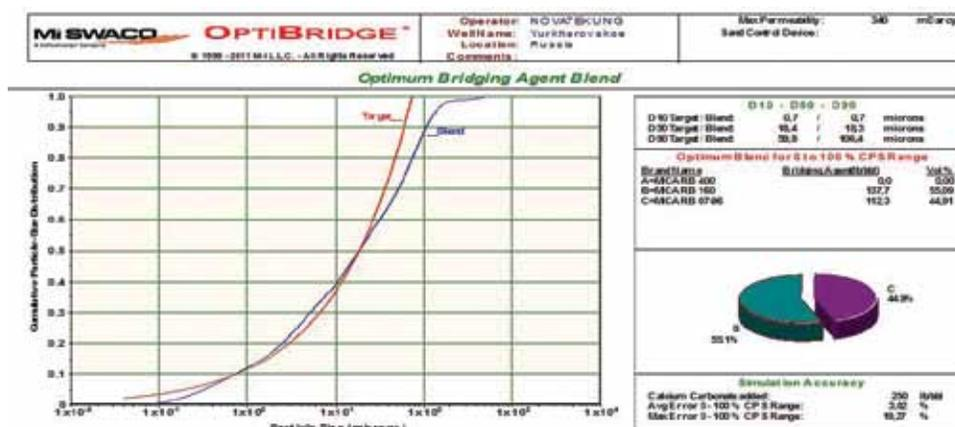
График 4. Подбор кольматантов для пластов БУ0 - БУ 30.Рекомендуемый состав кольматирующей пачки: CalciumCarbonate MEDIUM – 175кг/м<sup>3</sup> (70%); CalciumCarbonate FINE – 75кг/м<sup>3</sup> (30%).
