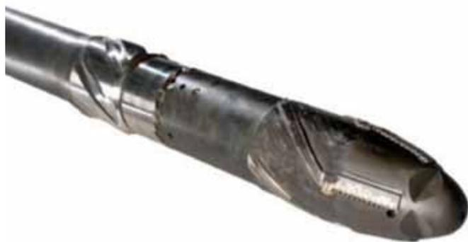
Рисунок 23. Прорабатывающий турбобашмак
