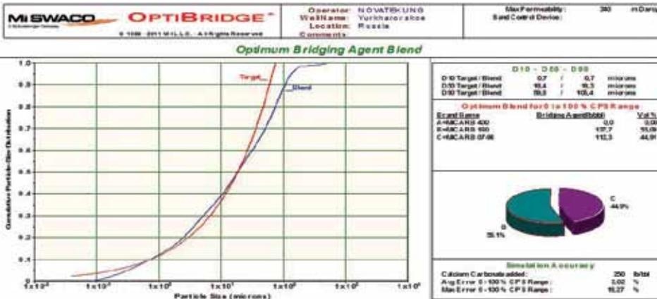
График 6. Подбор кольматантов для пластов БУ80 – БУ83 (покрышка БУ80 представлена «шоколадными глинами», БУ81, БУ82, БУ83 пласты, находящиеся в разработке, со сниженным пластовым давлением). Рекомендуемый состав кольматирующей пачки: Calcium Carbonate MEDIUM – 140кг/м<sup>3</sup> (55%), Calcium Carbonate FINE – 110кг/м<sup>3</sup> (45%)
