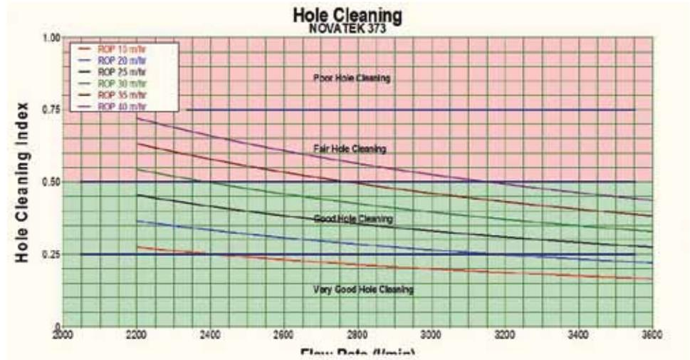
График 2. Зависимость индекса очистки от изменения МСП и производительности насосов (для секции 311мм)
