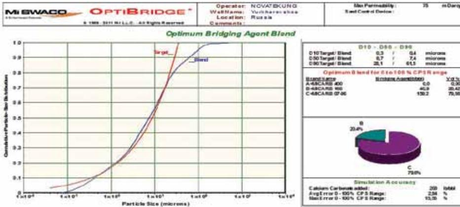
График 5. Подбор кольматантов для пластов БУ4 – БУ70. Рекомендуемый состав кольматирующей пачки: Calcium Carbonate MEDIUM – 40кг/м<sup>3</sup> (20%), Calcium Carbonate FINE – 160кг/м<sup>3</sup> (80%)
