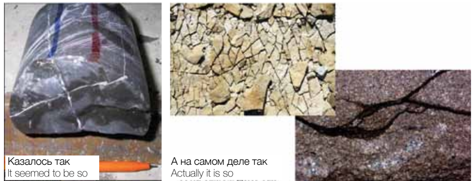
Рис.2. Представление о структуре нефтенасыщенных пород согласно образцу, поднятому непосредственно из залежи (слева) и действительное строение пласта согласно комплексному изучению (справа)
