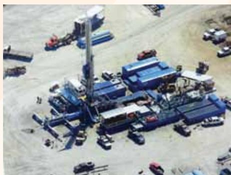
Современная гидравлическая буровая установка горизонтально-направленного бурения нового поколения (2013 г.)
