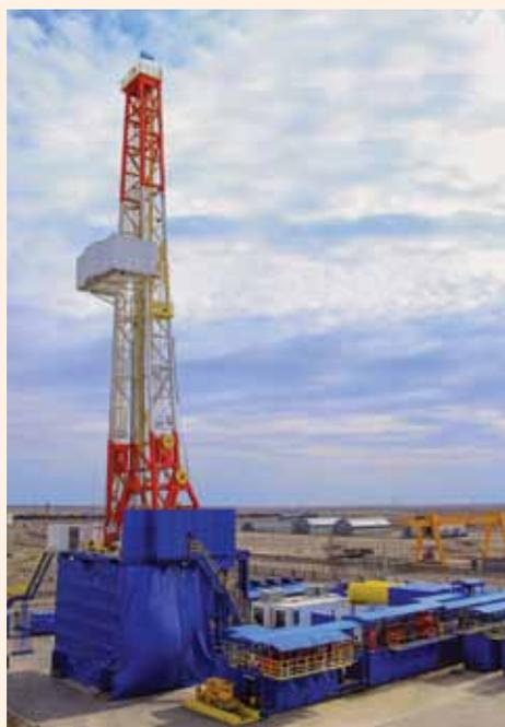
Новая (2014/15) SL2500 (2500 л.с.) буровая установка нового поколения с системой преобразования частоты переменного тока
