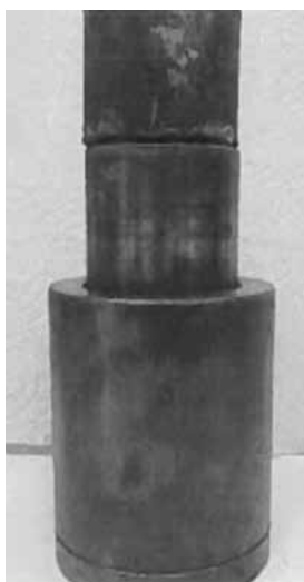
Рисунок 1: Ячейка, используемая для выдержки проппанта и определения его возможной активации Picture 1: The cell used for proppant curing and defining chances of its activation
