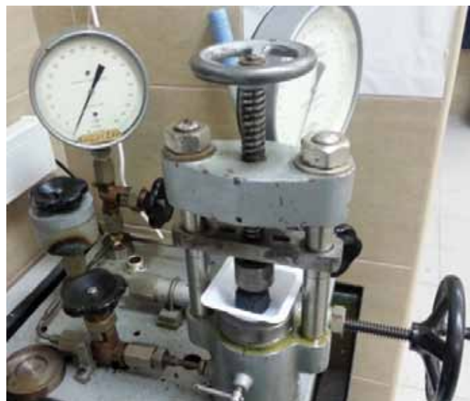
Рисунок 4: Пресс, используемый для определения предела прочности на разрушение образца пачки проппанта
