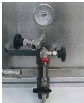
Рисунок 2: Ячейка для выдержки образца проппанта под давлением с возможностью отфильтровывания освобождающейся из образца жидкости Picture 2: The cell used for proppant curing under pressure with a released fluid filtering capability
