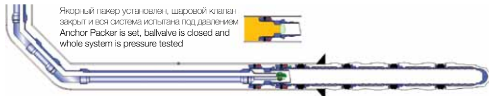
Рис. 7. Установка и опрессовка пакера-якоря Fig. 7. Anchor packer installation and testing
