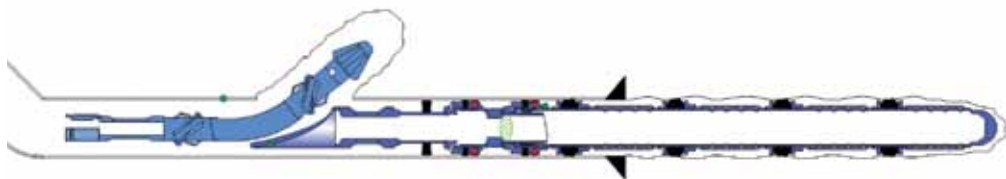
Рис. 8. Фрезерование окна в обсадной колонне Fig. 8. Casing exit operations
