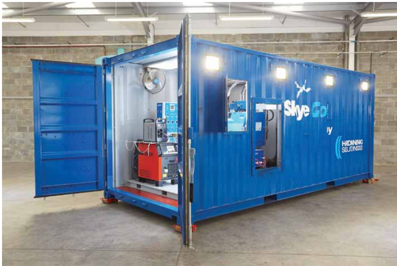
Рис. 2. Наплавочная установка в мобильном исполнении
