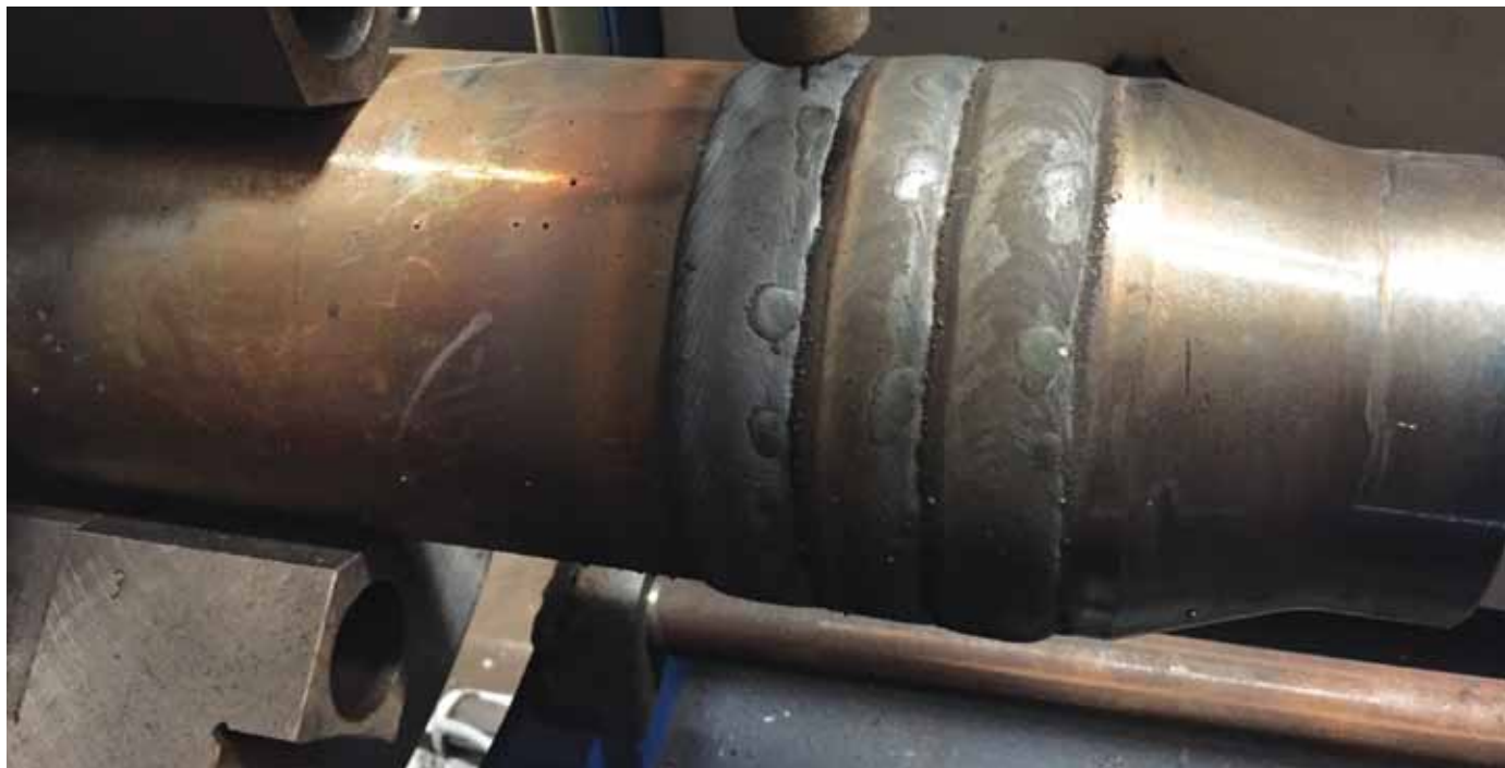
Рис. 1. Типовой технологический процесс наплавки
