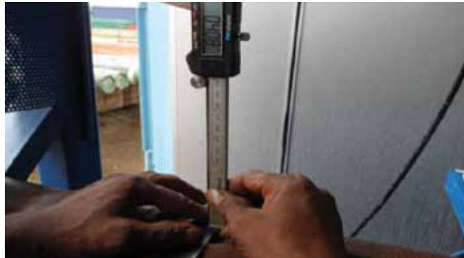
Рис. 7: Контроль размеров посадочного гнезда для RFID-метки
