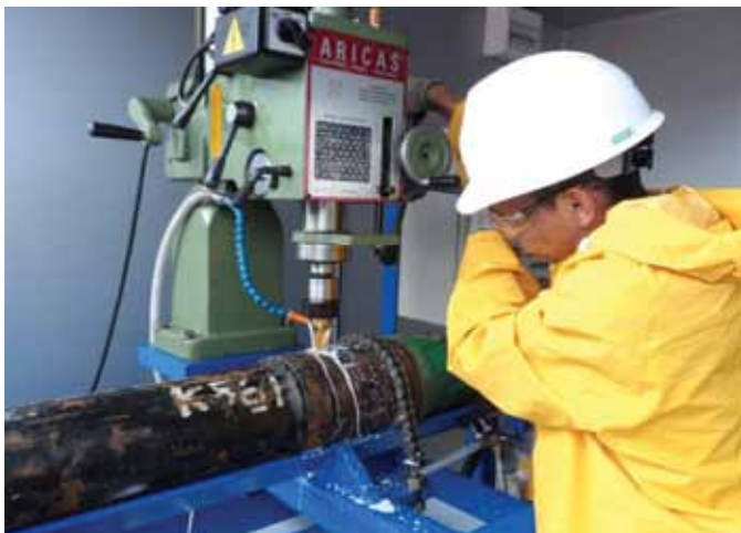
Рис. 6: Сверление посадочного гнезда для RFID-метки в бурильном замке
