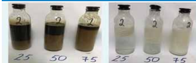
Рис 3: Результаты оценки рисков образования нерастворимых осадков при смешивании жидкости глушения с пластовыми флюидами Fig. 3: Results of the assessment of the risk of insoluble residues formation when mixing the killing fluid with reservoir fluids
