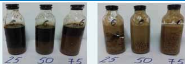
Рис 3: Результаты оценки рисков образования нерастворимых осадков при смешивании жидкости глушения с пластовыми флюидами Fig. 3: Results of the assessment of the risk of insoluble residues formation when mixing the killing fluid with reservoir fluids
