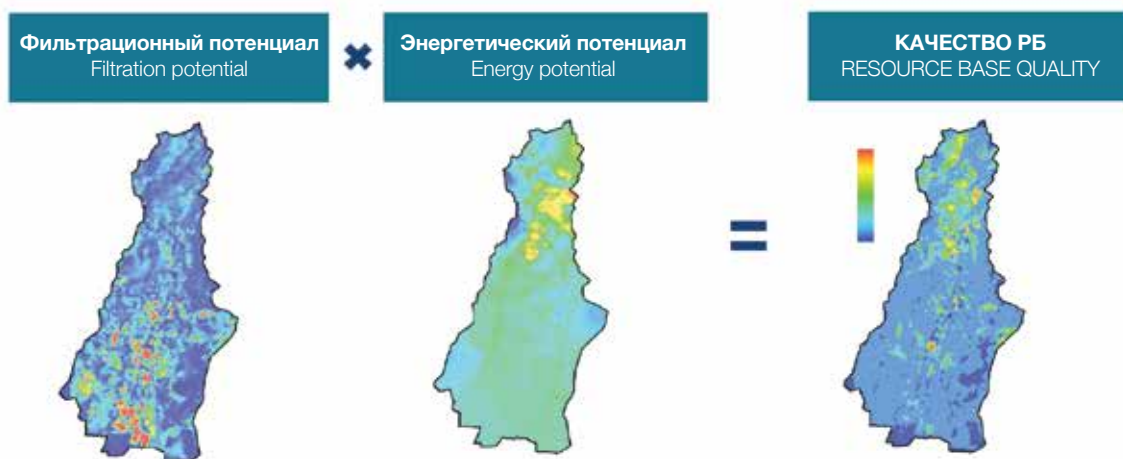
Рис. 3: Рисунок 3. Построение карты качества ресурсной базы Fig. 3: The resource quality map development
