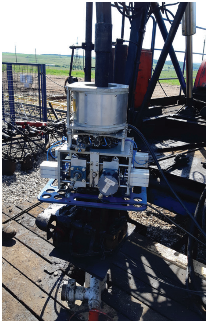
Рис. 2: Внешний вид мобильного комплекса диагностики НКТ Fig. 2: The mobile diagnostic equipment for tubing
