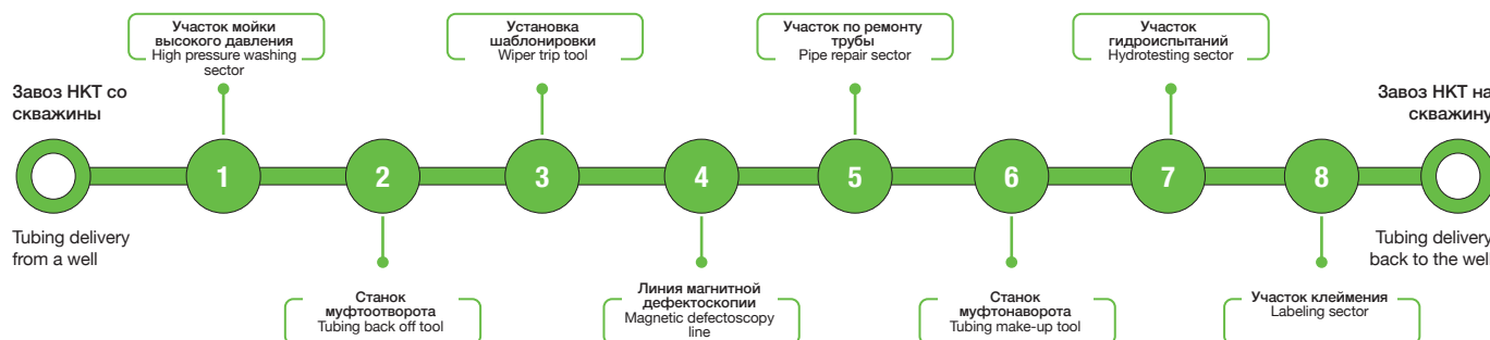
Рис. 1: Полный цикл диагностики и ремонта НКТ Fig. 1: The full cycle of the tubing diagnostics and repair
