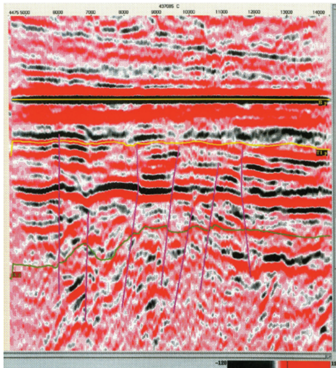
Рис. 2: Временной сейсмический разрез, выровненный по кровле отложений баженовской свиты
